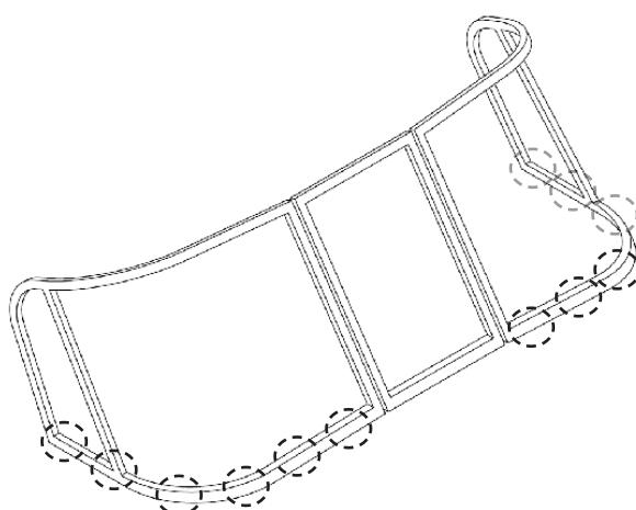
В нижнем профиле рамки есть отверстия, через которые будет осуществляться крепление ветрового стекла к корпусу лодки. В случае если по какой-то причине вы не можете использовать данные отверстия, необходимо самостоятельно просверлить профиль рамки в ближайшем доступном месте используя для этого сверло диаметром 4,8-5 мм.
