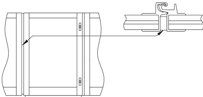
Наклеиваем уплотнитель 6х12 в проём калитки.
