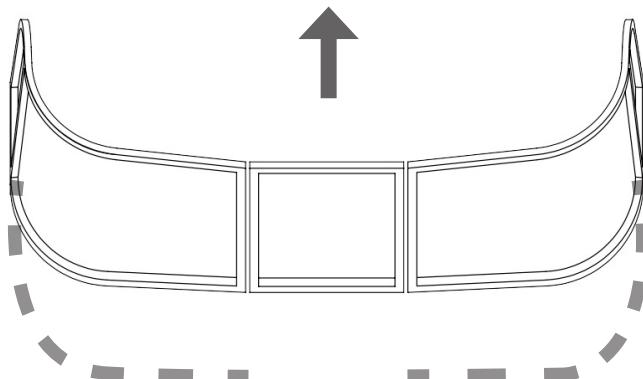
7.1 Откручиваем рамку от палубы лодки и снимаем её.
