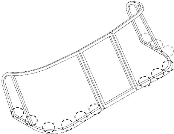
Затем в отмеченных ранее точках, с помощью сверла 4,8 мм в палубе лодки просверливаем отверстия и фиксируем рамку к корпусу лодки винтами M4x40
