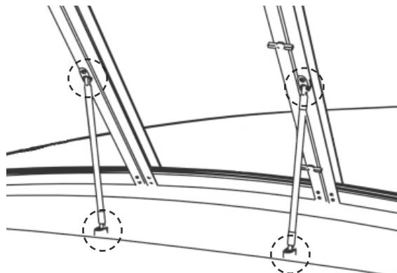
Устанавливаем упорные стойки «враспор» обеспечивая оптимальную геометрию створа калитки.
