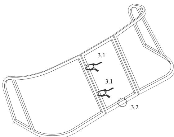
3.1 Зафиксируйте створ калитки при помощи струбцин или зажимов обеспечив зазор 3 мм в притворе.
