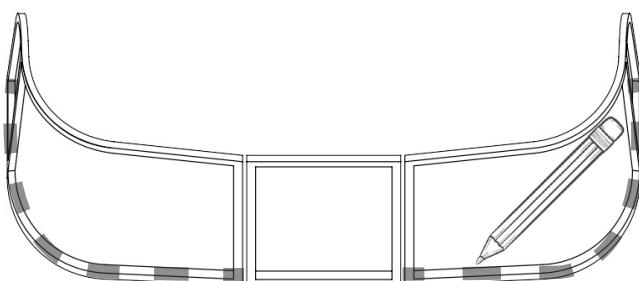
Очерчиваем контур рамки карандашом для наклеивания уплотнителя (под рамку) с клеевой основой.
